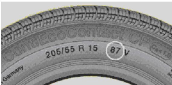
L'indice di carico indica quanto carico può sopportare il singolo pneumatico. Il carico per asse degli assi anteriore e posteriore è indicato nei documenti del veicolo. Lo pneumatico deve avere una capacità di carico superiore al carico per asse/2 (poiché sono montate due ruote per asse).
